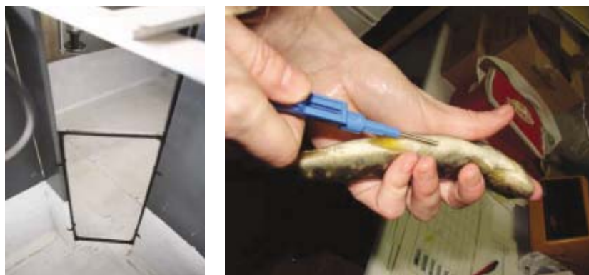
Figura 66 Ubicación de una de las antenas en la hendidura de la escala y colocación de un microchip en un pez.
