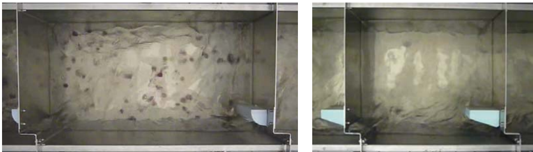
Figura 61 Vista en planta del diseño D8_15 tipo II con los trazadores utilizados para definir el patrón de flujo mediante observación visual (izquierda) y vista en planta del diseño D8_10 tipo III (derecha).
