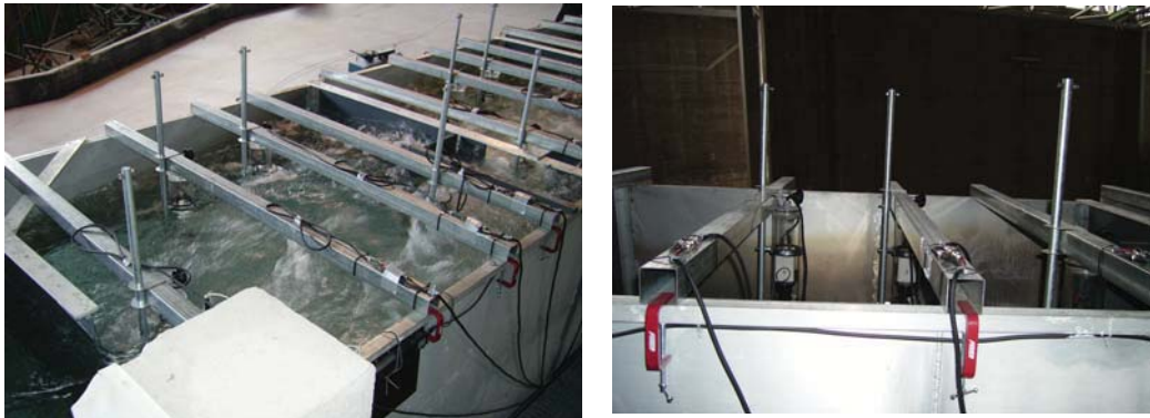
Figura 64 Disposición de la red de cámaras instalada en el modelo con las correspondientes estructuras de soporte.
