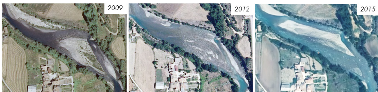
Figura 1 | Tramo de estudio río Ésera en Perarrúa. La barra existente (2009) fue completamente eliminada durante una extracción de gravas (2012), y está volviendo a formarse en la actualidad (2015).
