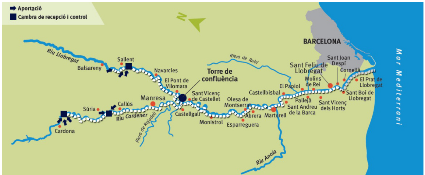
Figura 1 | Esquema del colector de salmueras de la cuenca minera del Bages (Cataluña). Fuente: ICL Iberia
