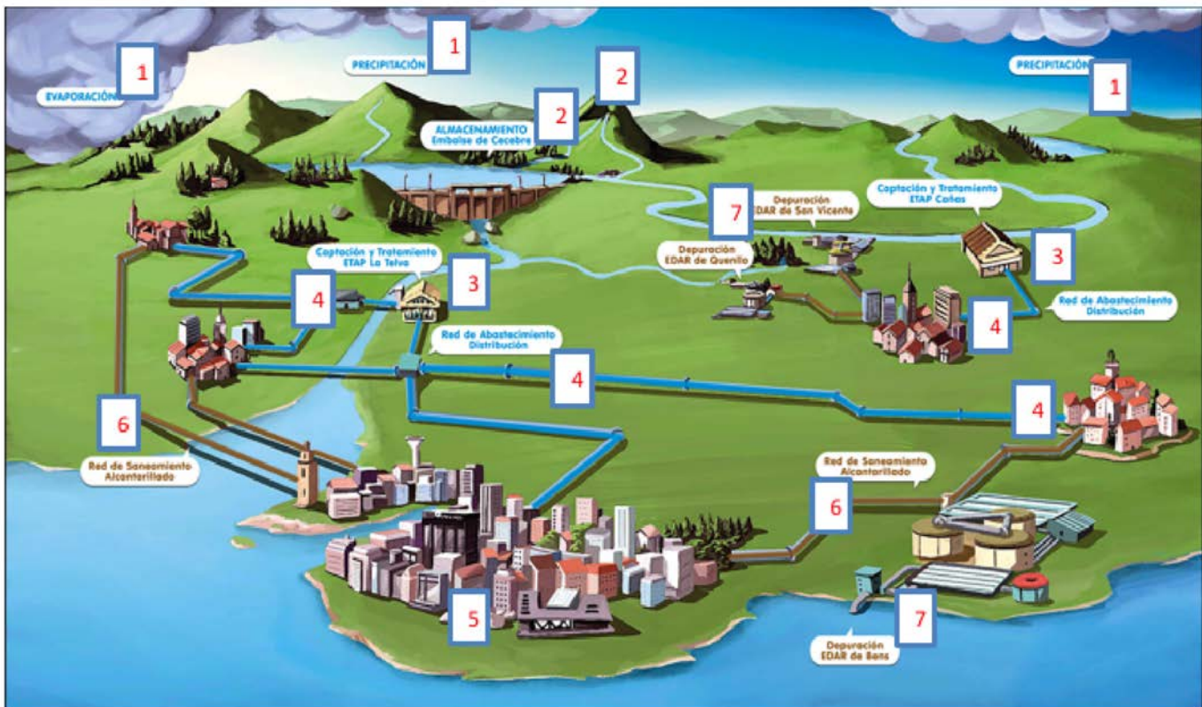
Figura 1 | Esquema del abastecimiento y saneamiento metropolitano de A Coruña
