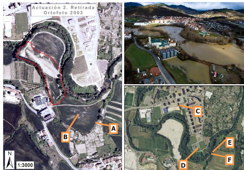
Figura 1 | Ortofoto del 2003 que muestra huellas de la trayectoria de la avenida de febrero de 2003 en ausencia del relleno. La línea roja muestra la actuación 2 (izda.) inundación de junio de 2013 (dcha. arriba) y foto aérea del relleno de Huarte (dcha. abajo)
