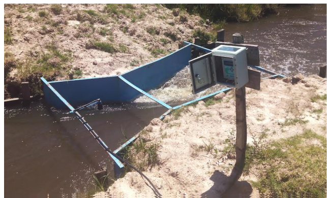
Figura 1 | Izquierda, aforador ACA instrumentado con ESPAY-gprs con sensor piezo-resistivo. Derecha, aforador sin cuello N° 24 instrumentado con ESPAY-gprs con sensor electroacústico (Eco ultrasonido)
