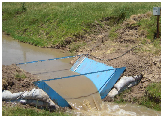
Figura 1 | Izquierda, aforador ACA instrumentado con ESPAY-gprs con sensor piezo-resistivo. Derecha, aforador sin cuello N° 24 instrumentado con ESPAY-gprs con sensor electroacústico (Eco ultrasonido)
