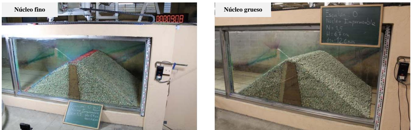
Figura 12 | Configuración de las presas construidas en laboratorio con núcleo fino (izquierda) y núcleo grueso (derecha) antes del ensayo.
