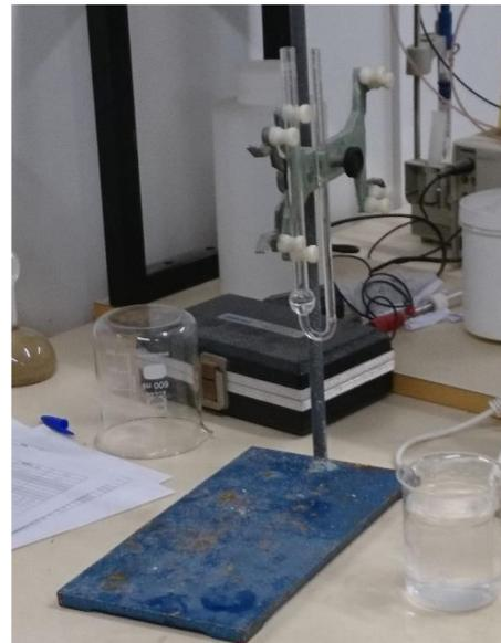
**Figura 2** | Esquema (izquierda) y fotografía (derecha) del viscosímetro de Ostwald utilizado.
