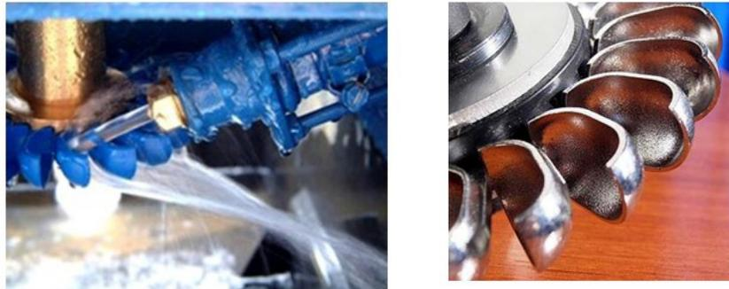
Figura 4 | Posición del chorro en una turbina Turgo y un rotor tipo (Ref: <http://www.varspeedhydro.com/Turgo.html>).
