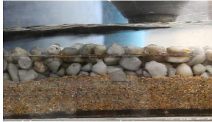
**Figura 2** | Inicio del vertimiento de concentrado en un lecho con una configuración de dos capas, la capa superficial es de gravas y la subsuperficial de arenas.
