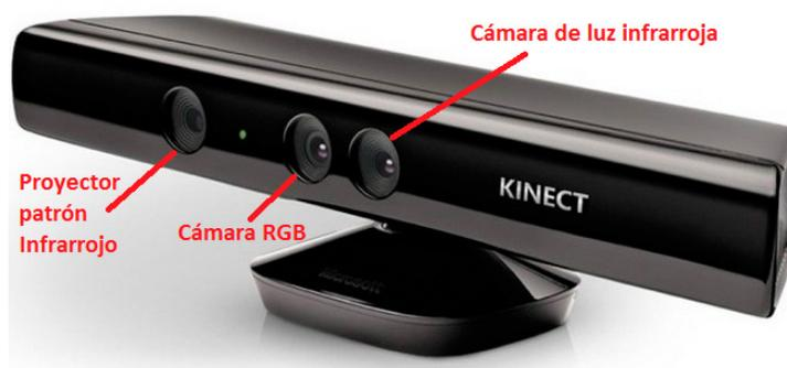
Figura 1 | Dispositivo Kinect utilizado.
