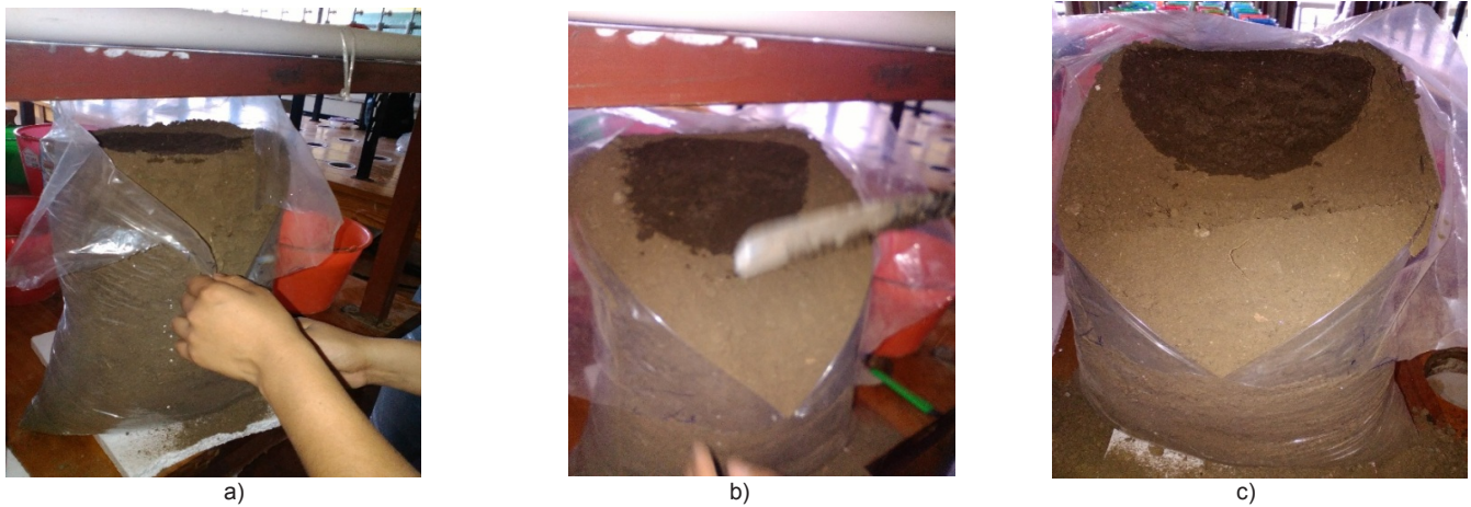
Figura 3 | Preparación del contenedor para la medición geométrica y toma de muestras de suelo del bulbo húmedo.
