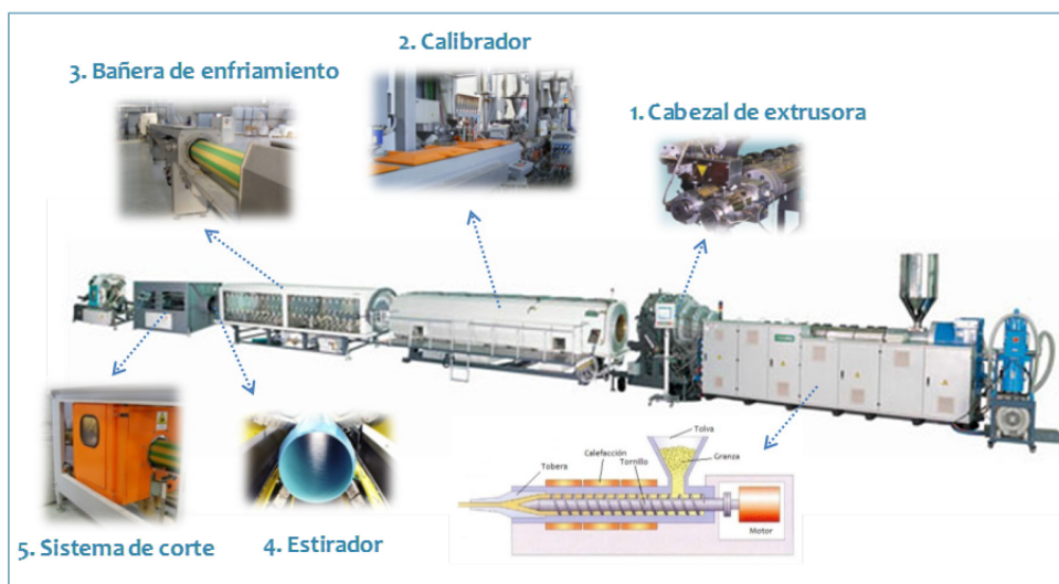
Figura 2 | Esquema de una extrusora de tuberías
