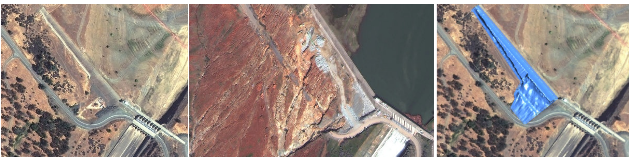
Figura 15 | Izquierda: vista aérea del aliviadero de emergencia de la presa de Oroville antes del incidente de 2017. Centro: situación después del incidente, donde se observa erosión generalizada en la ladera. Derecha: Simulación numérica de la solución propuesta, donde se aprecia la concentración del vertido en una zona reducida, aguas abajo de la cual debería implementarse el sistema de protección frente a la erosión. Como se aprecia la zona a proteger es de mucha menor extensión que en un escenario sin cajero lateral (imagen central).
