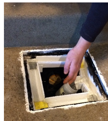
Figura 2 | Esquema del sistema de medida de caudales y de toma de muestras en la entrada de la red de drenaje (a). Imágenes de la toma de muestras manuales en las arquetas (b).
