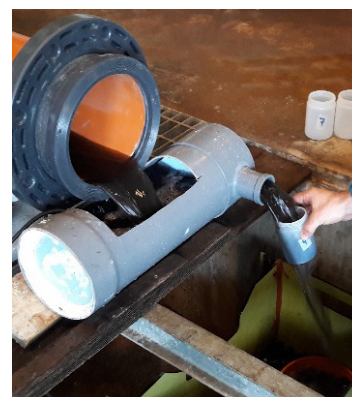
Figura 3 | Esquema del sistema de medida de caudales y de turbidez en la salida de la red de drenaje (a), e imagen de la toma de muestras manuales a la salida del depósito donde se mide la turbidez (b).
