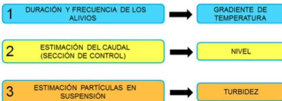
**Figura 7** | Variables medidas y objetivos de las misma en el sistema de monitorización implementado en el proyecto BINGO.
