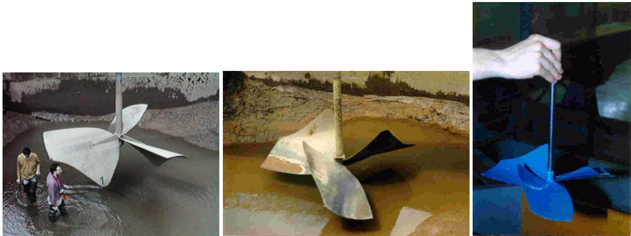
Fig. 1.- Palas de los agitadores y reproducción a escala en el modelo reducido
