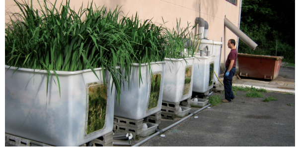
Figura 5. Módulos piloto de humedales de flujo vertical de tratamiento de aguas residuales (GEAMA, 2011)
