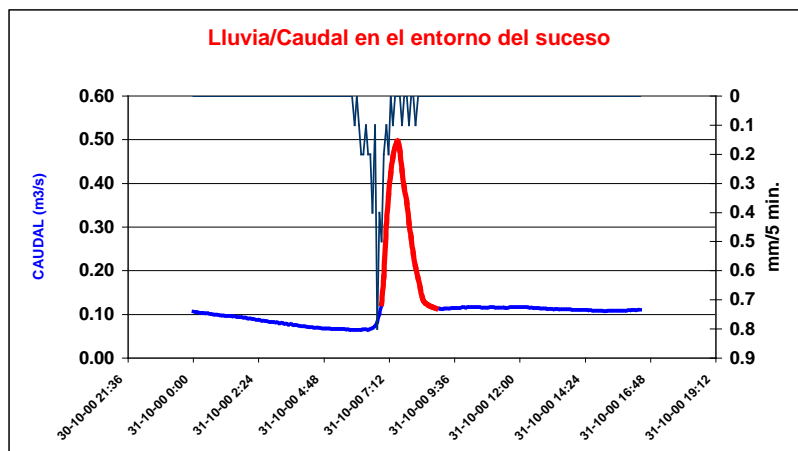
Figura 2.- Hietograma e hidrograma del “Suceso Sevilla 03”.
