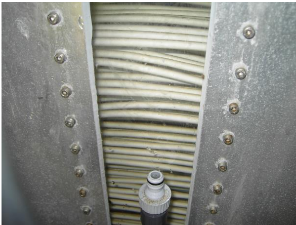
Fig. 1.- Reactor prototipo de membranas tubulares antes del arranque (izda.). Imagen de las membranas tubulares micro-porosas recubiertas de biopelícula nitrificante (dcha.)
