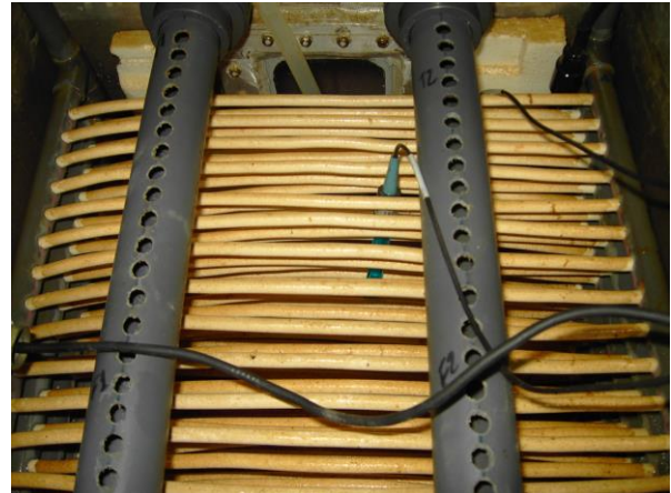
Fig. 1.- Reactor prototipo de membranas tubulares antes del arranque (izda.). Imagen de las membranas tubulares micro-porosas recubiertas de biopelícula nitrificante (dcha.)
